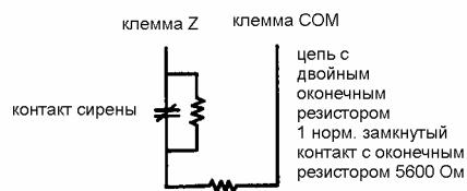
Двойные оконечные резисторы позволяют панели определить состояние зоны - сигнал тревоги, неисправность или ложный сигнал.
